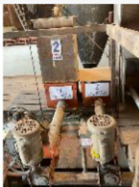
bac à minéral Valmetal avec vis rigide 4" et moteur 1/2hp avec drive
