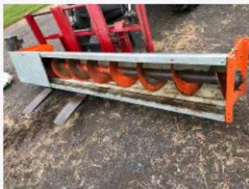
Convoyeur à vis Val Métal 8' moteur 2hp
