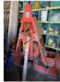
TREUIL À BOIS FARMI - DIAMÈTRE DU CABLE 10MM
